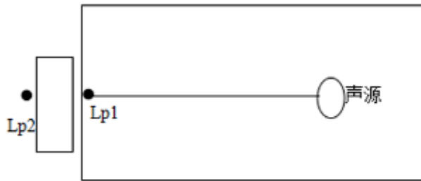
图 4-2 室内声源等效为室外声源图例
