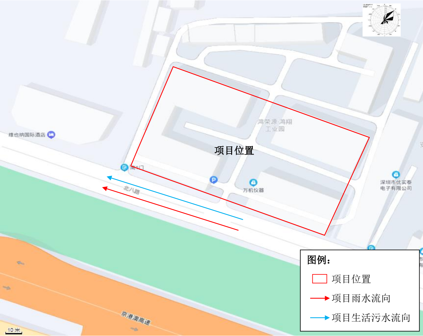
附图 13：项目排水管线平面布置及排水路径示意图
