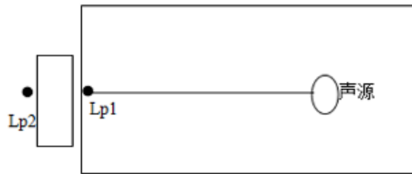
图 4-2 室内声源等效为室外声源图例
