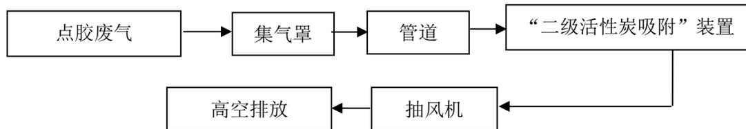
图 4-1 项目废气处理工艺流程图
