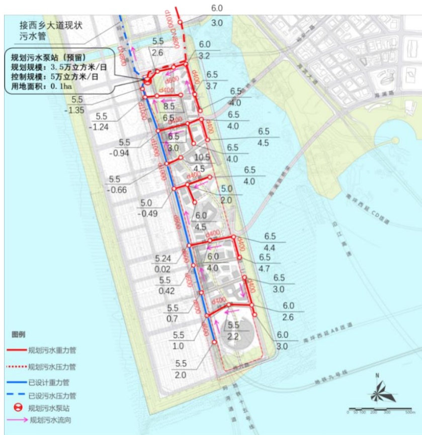
图 2-1 DY01-05 污水泵站外部管网图
