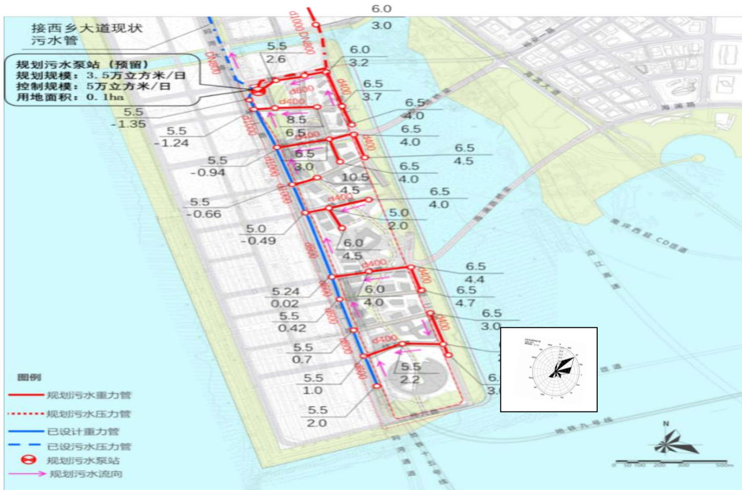
附图16 污水泵站外部管网图
