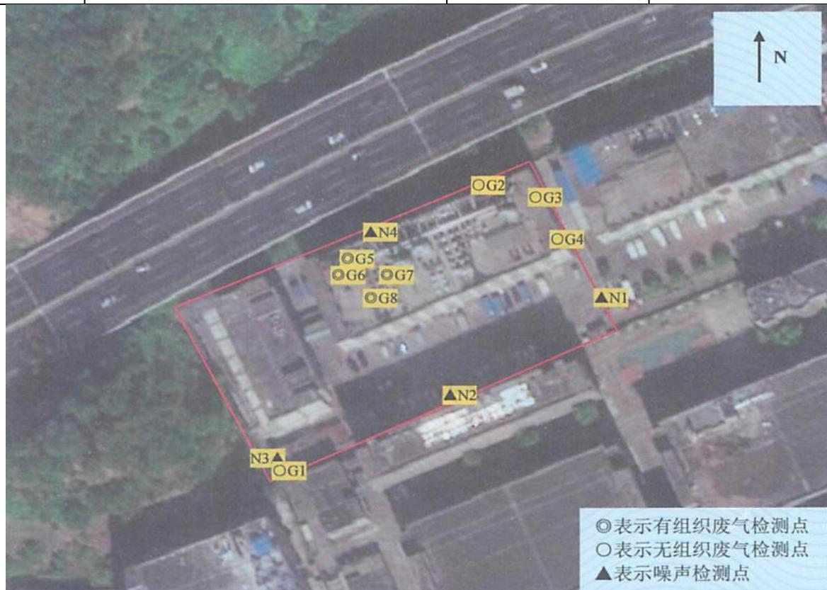
图 6-1 项目废气、噪声环境监测点布置图
